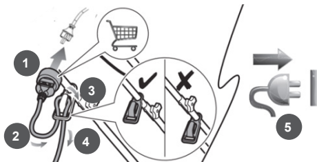
Рис. 8 Фиксация кабеля удлинителя на рабочей рукоятке.
